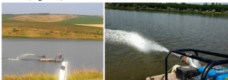
Fig. 2 În piscicultura autohtonă adesea se folosesc pompele mobile instalate pe bărci care pulverizează apa din bazin
