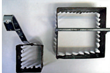
Fig. 4. Rame metalice cu latura de 5x5 și 10x10 cm 2 pentru colectarea eșantioanelor de sol (Bușmachiu G., original).
