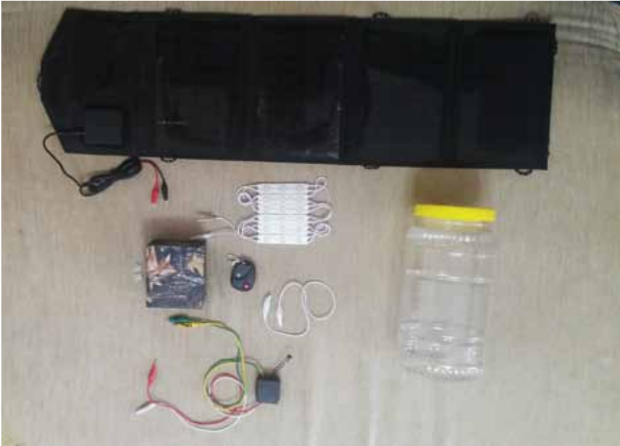
A 7.2 Componentele de bază a dispozitivului de iluminare autonomă folosit în pescuiturile ameliorative și nutriția peștilor cu hrană naturală în heleșteie
